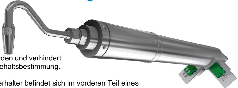
Ein auswechselbarer Planfilterhalter befindet sich im vorderen Teil eines beheizbaren Absaugrohrs. Um diesen Planfilterhalter und dessen Einlaufkonus ist eine zweite Hochleistungs-Heizpatrone gewickelt und vermeidet somit Taupunktunterschreitung am Filter.
