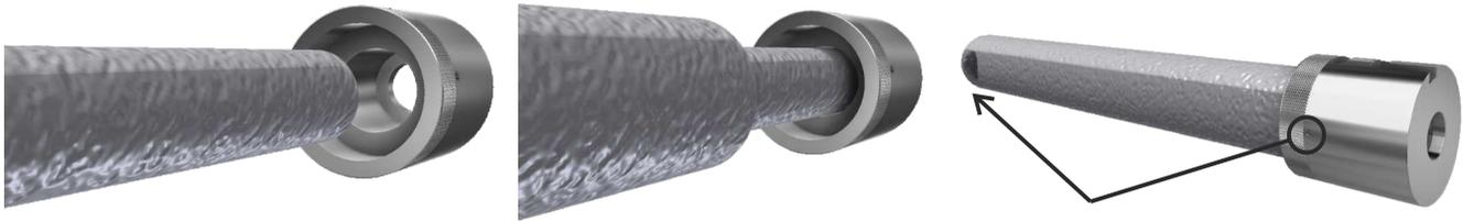
Zuerst wird die Innere Keramik mit dem Zement in die Fassung vom Bajonett gedrückt, danach die Äußere. Die äußere Keramik so positionieren, dass die kleine Bohrung (Markierung) und die Öffnung übereinstimmen.
