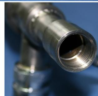
**Achtung: Bei Rohren > 1,5 m kann das Gewinde nur festgeschraubt und gelöst werden, wenn das Pyrometer senkrecht gehalten wird!**
