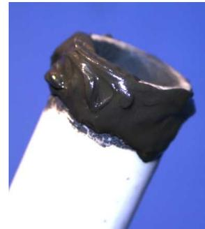
Erst innere, dann äußere Keramik einsetzen. Heizluftfön auf Edelstahlteil halten: ~3 min bei 100°C, 5 min bei 500°C.
